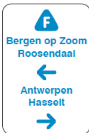
Figuur 66: Ontwerp oprijbord bij dubbelopende fietssnelwegen
