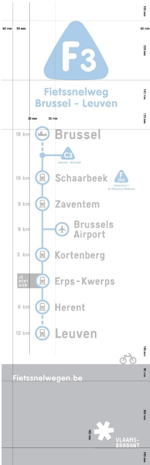
Figuur 49: afmetingen routezuil
