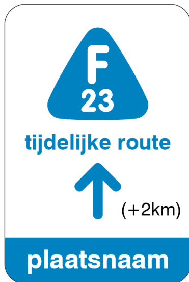
Figuur 37: Ontwerp aankondigingsbord bij tijdelijke omleiding omwille van ontbrekende schakel in de fietssnelweg
